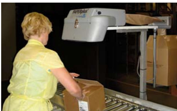
Een aangepaste Shooter machine brengt het materiaal dichterbij de verpakker.
