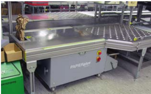
Voorbeeld van een Classic tafelverpakingsmachine, geïntegreerd in een verpakingslijn.
